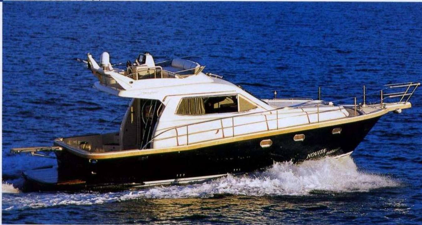
Sopra, il Portofino 37 nella fase d'ingresso in planata. Lo scafo raggiunge il suo migliore assetto intorno a 25 nodi, una velocità di crociera ideale alla quale si registrano consumi contenuti che consentono un'autonomia di circa 350 miglia.
